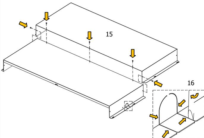
17. Agganciare il pannello inferiore alle due viti del modulo inferiore e avviare le 6 viti Ø3.9x13.
