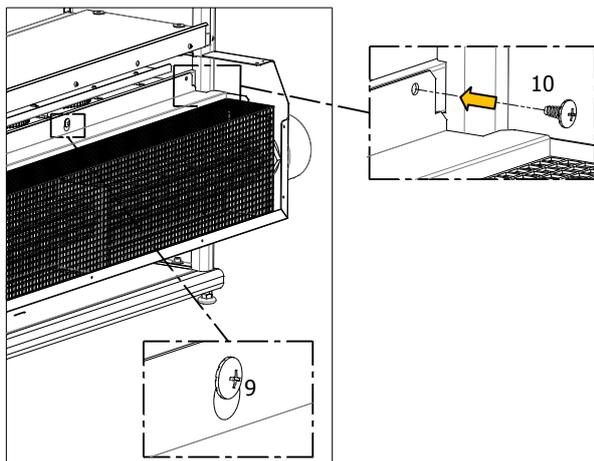
11. Fissare il riscaldatore ai montanti del modulo tramite due viti Ø3.9x13.
