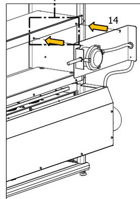
15. Assemblare il pannello inferiore utilizzando 5 viti Ø3.9x6.5.
