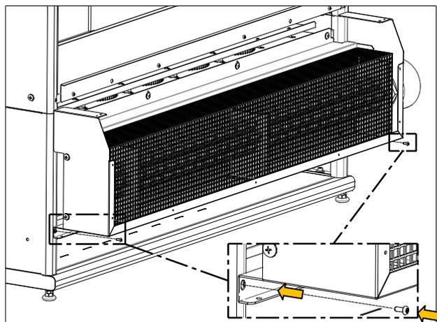
12. Fissare la chiusura al riscaldatore con nove viti Ø3.9x13.
