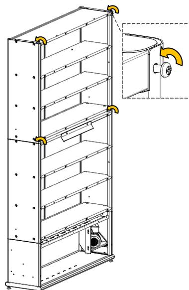
7. Avvitare due viti nere Ø4.8x9.5 nei fori centrali del ripiano del modulo inferiore, lasciando 3-4 mm tra la testa della vite e il ripiano.
