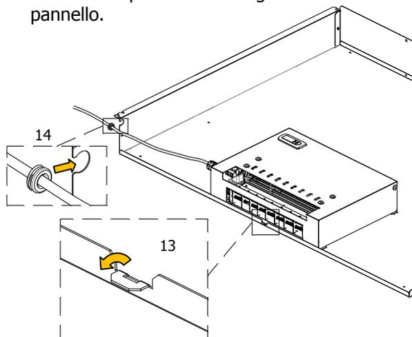
15. Agganciare il pannello con il termostato alle due viti del modulo superiore facendo attenzione a non schiacciare il cavo della sonda e a inserire nella fessura del pannello inferiore la linguetta piegata precedentemente (23a).
