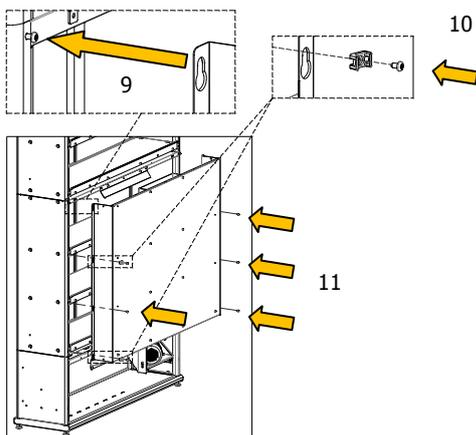
12. Fissare la chiusura inferiore con 3 viti Ø3.9x13.
